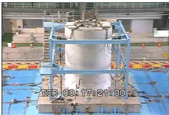
図1 大型三軸振動台による実物大コンクリートキャスク耐震試験
