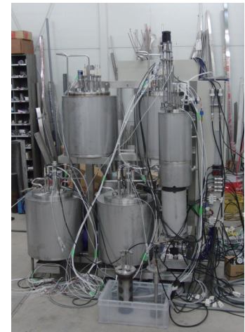
図2 高温融体輸送基礎試験装置
