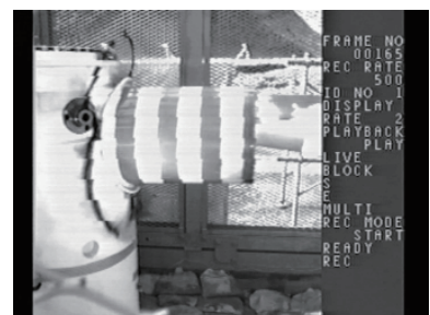
図 3 縮尺金属キャスクモデルを用いた水平衝突に対する衝撃実験概要
