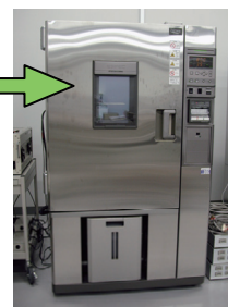
図5 ステンレス鋼が SCC で破損する時間を調べるための試験 比較的高温(80°C)で、海塩が十分に湿る湿度(35%)に設定し、さらに十分な量の塩(海岸沿いの屋外相当)を試験片に塗布した。
