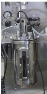
図3 幌延試料を用いた酸化還元模擬試験 JAEA 幌延深地層研究所(深度約140m)において採取した堆積岩および地下水試料を用いて処分環境変化を模擬した室内試験(ジャーファーマンター試験:写真)を行い、酸化還元電位の低下には微生物反応が大きく寄与していることを明らかにした。
