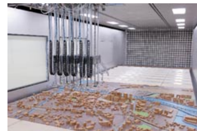
都市の気流・拡散状況の再現例(実験状況)
