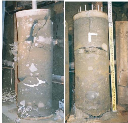
図4 試験後回収した試験体 (左：三軸圧縮試験後、右：三軸引張試験後)
