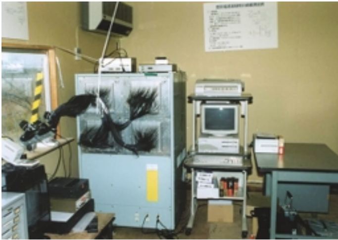
当所で開発した雷放電自動観測装置(ALPS)と上向き雷撃の観測結果 (ALPS:Automatic Lightning-discharge Progressing-feature observation System)
