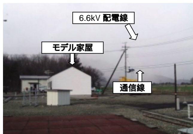
需要家低圧・通信回路の雷特性実験設備(写真2)
