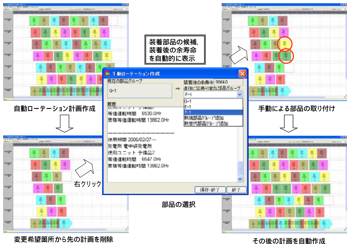
図1 手動による部品ローテーション計画作成の一般的な手順
