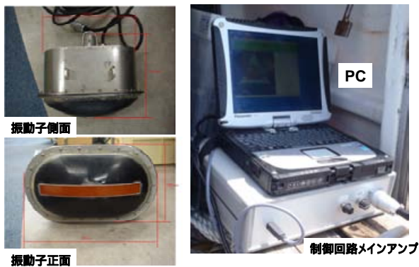
図1 試作したクラゲ検知システム 図左のコンベックス型の振動子ドームとメインアンプおよびPCから構成される。
