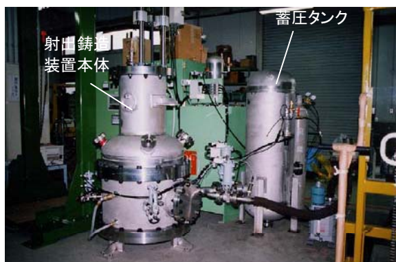
図2 工学規模射出鑄造試験装置 U-Zr 最大溶解量約 20kg (実用規模は 20~50kg)、 原子燃料工業(株)東海事業所に設置
