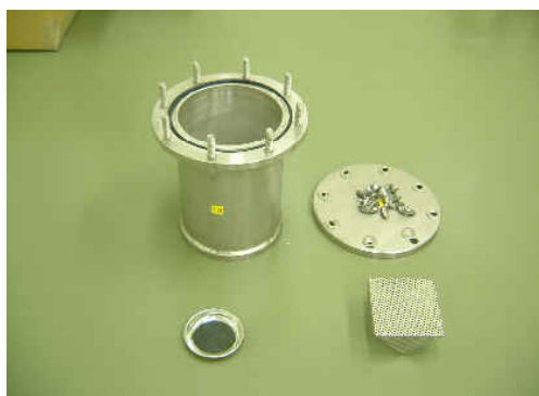
図1 同位体交換法に用いる試験容器の写真と概念図
