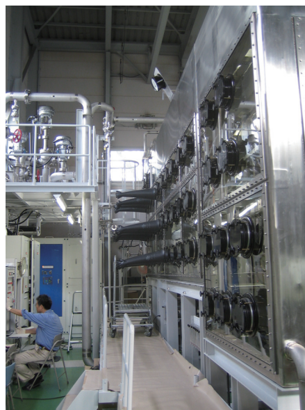
図2 大型Ar雰囲気グローブボックス
