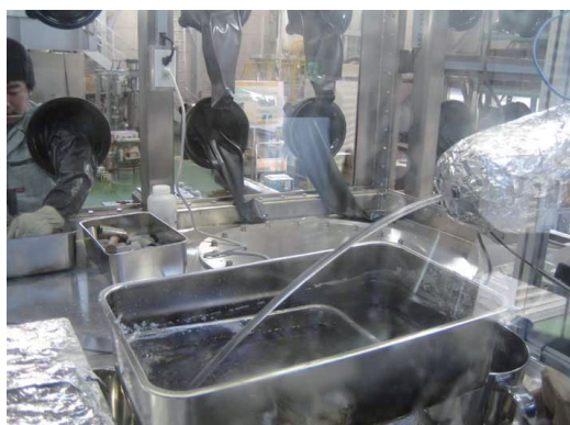
図3 重力での溶融塩の流出挙動
