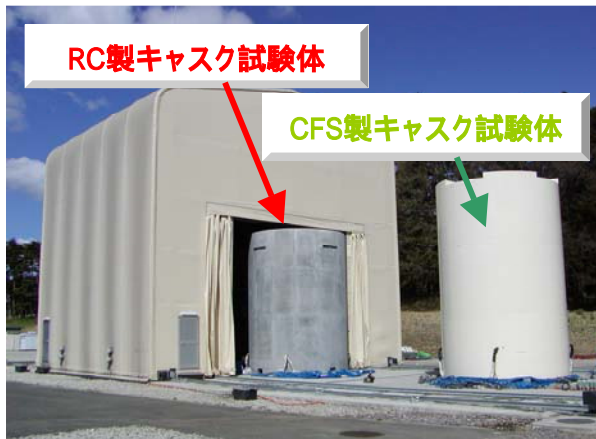
図1 実物大コンクリートキャスク試験体
