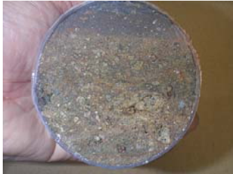
簡易ボーリングにより取得した透水試験サンプル（ガウジ～角礫帯部位）
