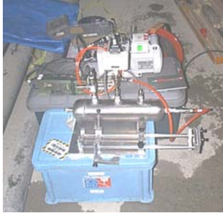
コアガス採取状況
