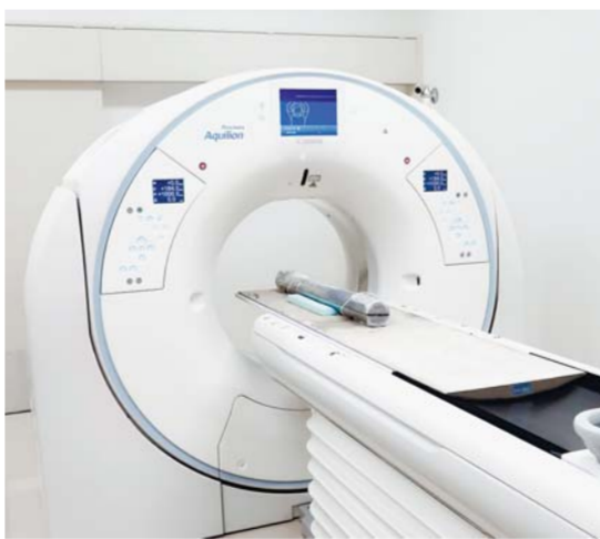
ボーリングコア観察に活用するヘリカルX線CTや透過型電子顕微鏡
