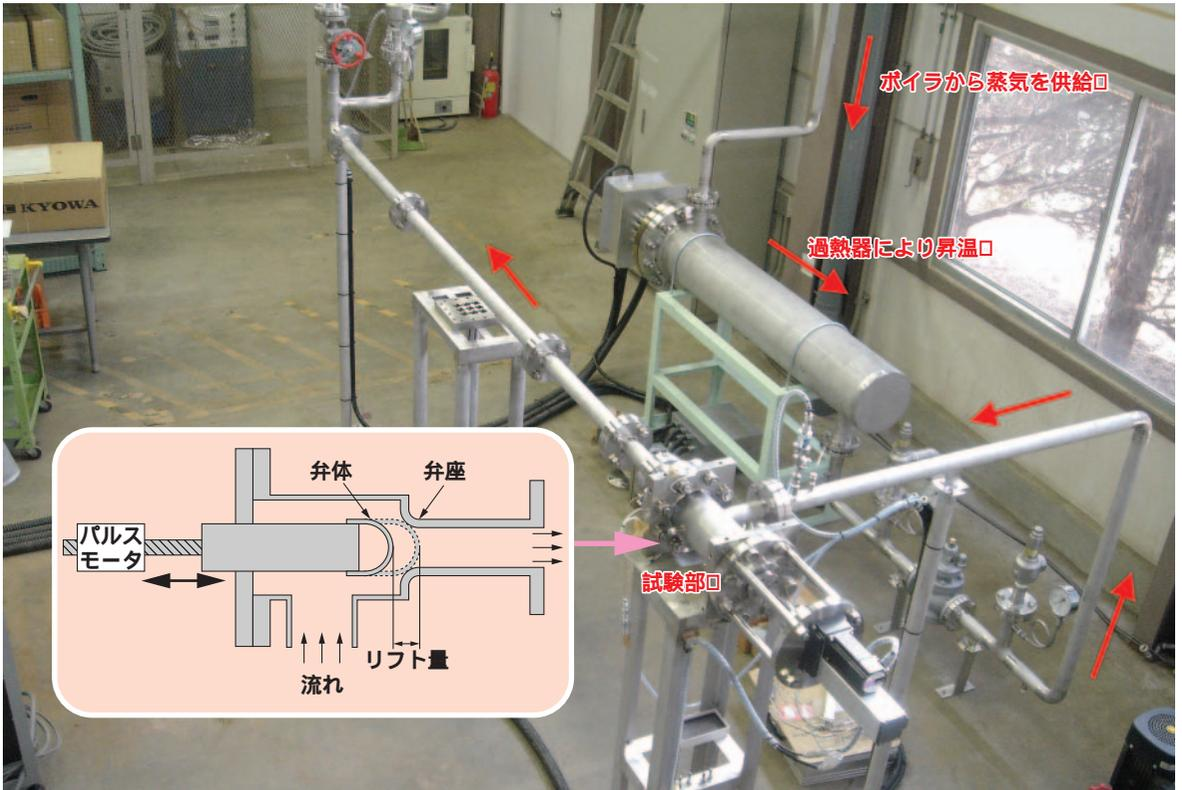
流動による弁の振動を計測する蒸気試験設備
