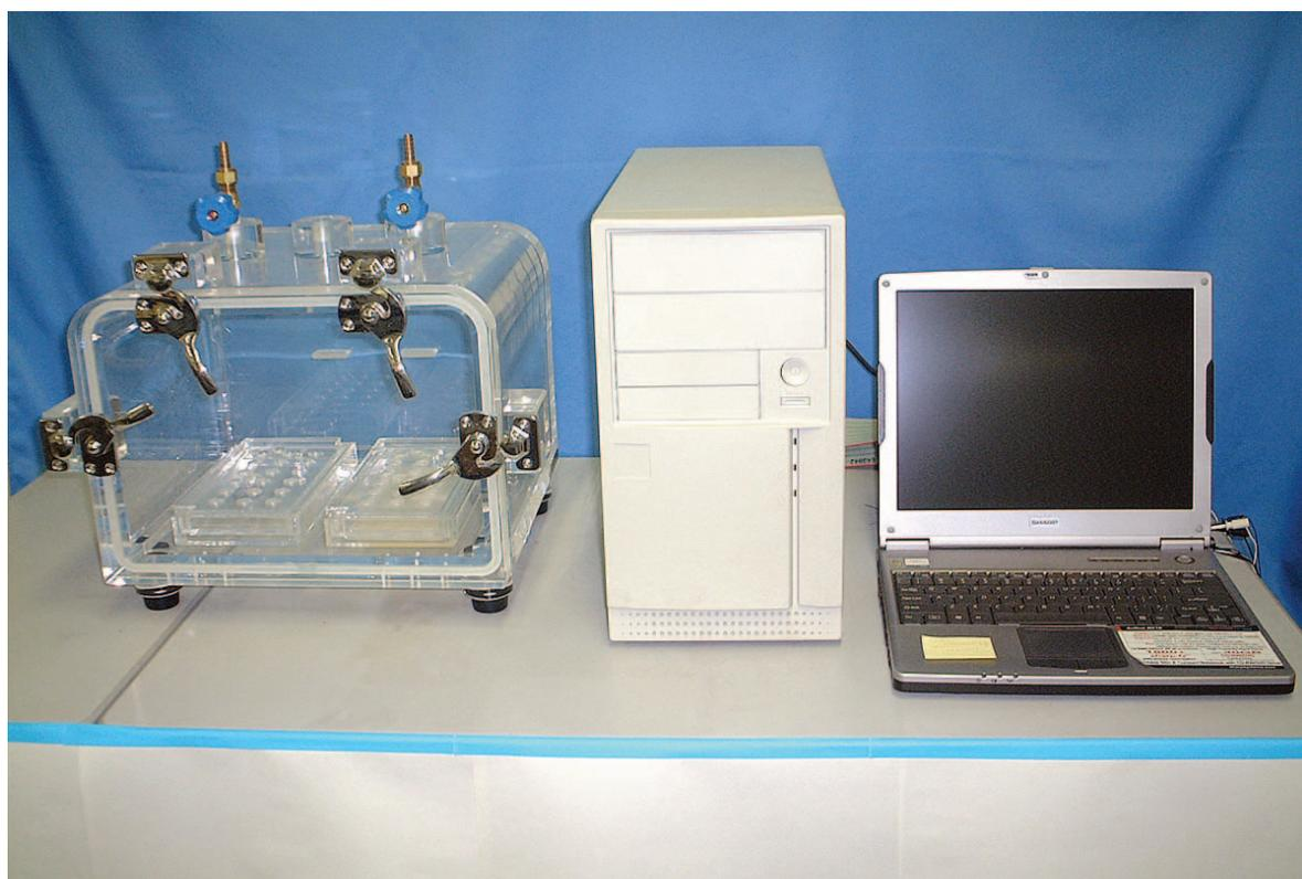
新型マイクロアレイ電気培養装置（試作機）
