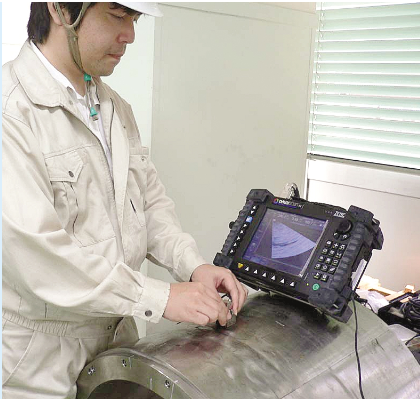
超音波探傷検査の様子（写真は模擬配管）
