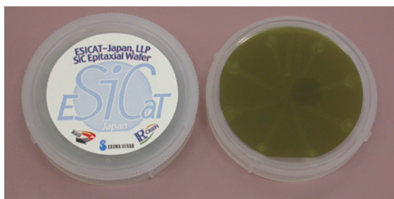
図4 技術移転先にて生産されたSiCエピタキシャルウェハ
