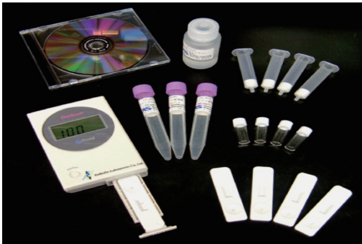
重金属の簡便な測定が可能である測定用セット一式（写真はカドミウム測定用）
