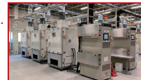
二次電池評価試験設備
