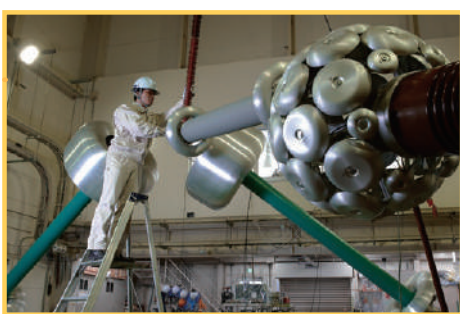
CVケーブル絶縁特性試験設備
