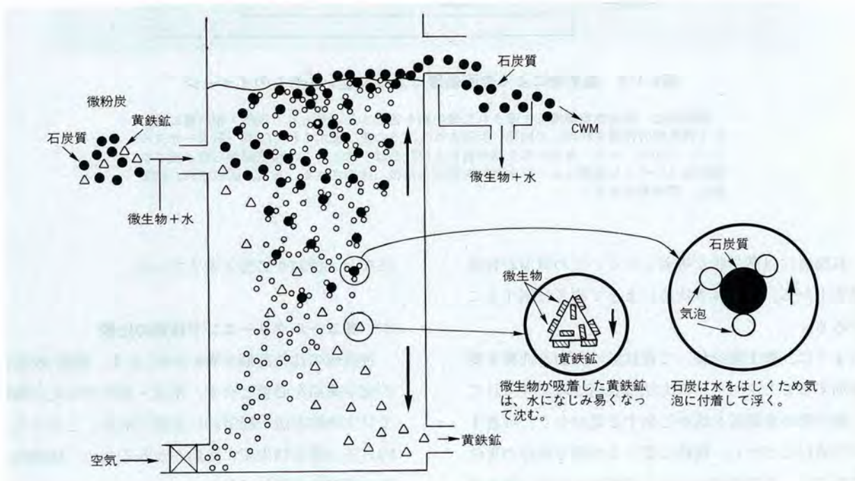
図3-1-8 微生物による表面処理の原理
