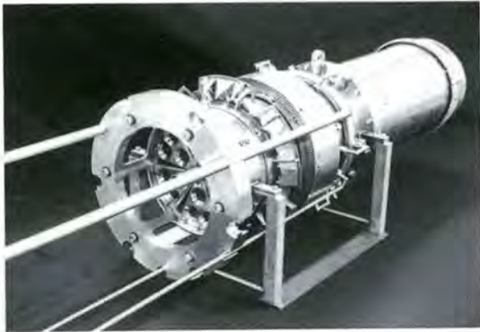
図5-3-4 複合型触媒燃焼器の外観
