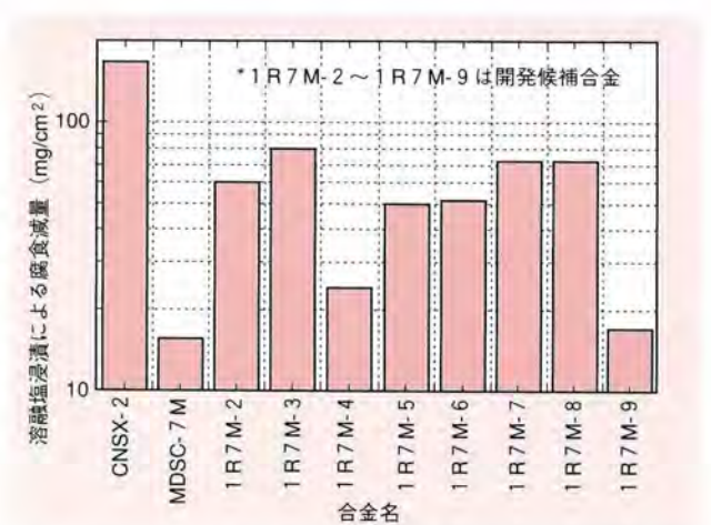
図3-2-2 溶融塩浸漬試験に伴う各超合金の腐食減量
