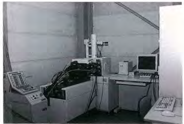
図7-2-4 ガスタービン高温部品ミニチュアサンプル強度試験装置
