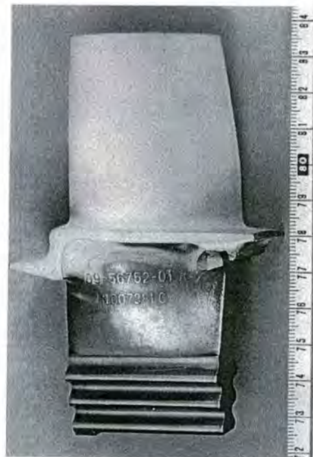
図2-1-6 熱コーティングを施した動翼の例 (2)
