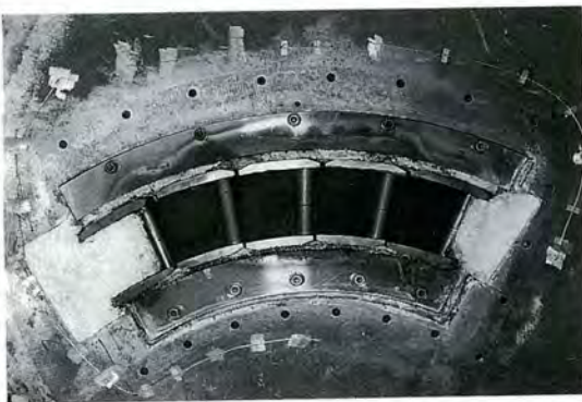
図4-4-6 試験後のセラミック静翼
