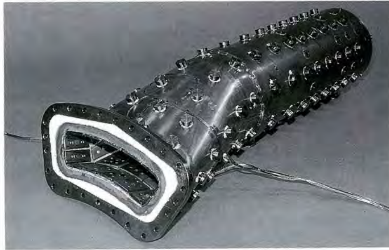
図4-4-3 試験後のセラミック燃焼器
