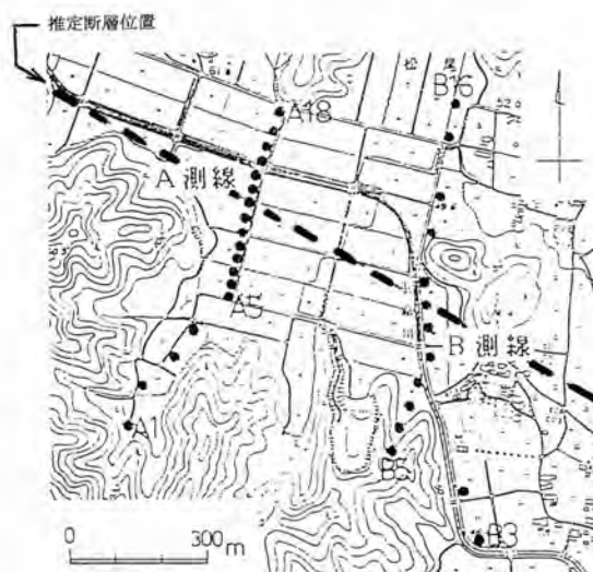
(b) CSAMT法測点位置図 (黒丸印が測点位置)
