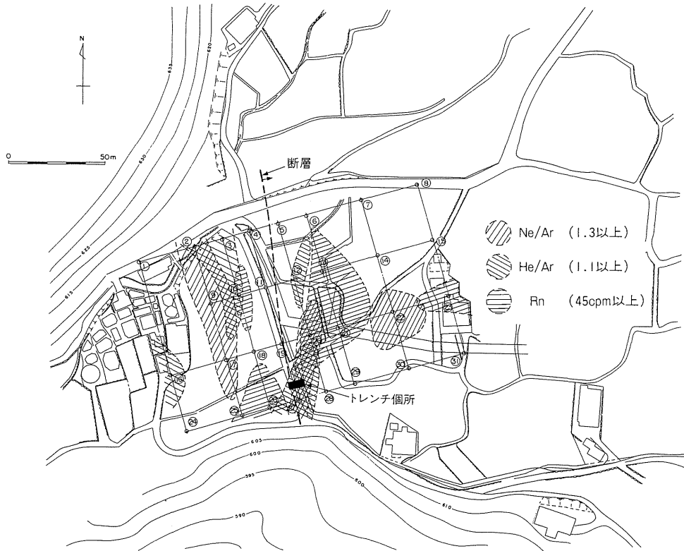
図2-1-3 地中ガスと断層の関係 (阿寺断層系萩原断層)
