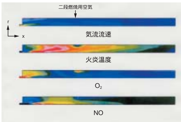
図9-3-3 主流方向気流流速、火炎温度および O_2 、NO濃度の炉内分布 (ニューランズ炭)
