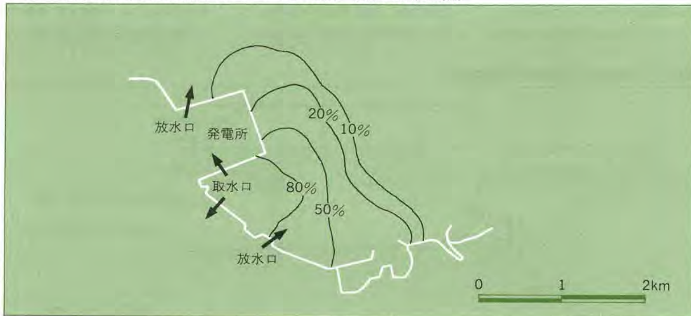
図2-2-6 冷却水取水に伴う取り込み確率のシミュレーション結果の一例(粒子投入後24時間)
