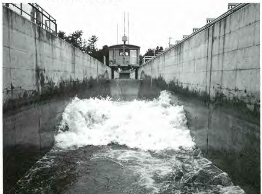
図2-2-16 海岸変形実験用の大型造波水路
