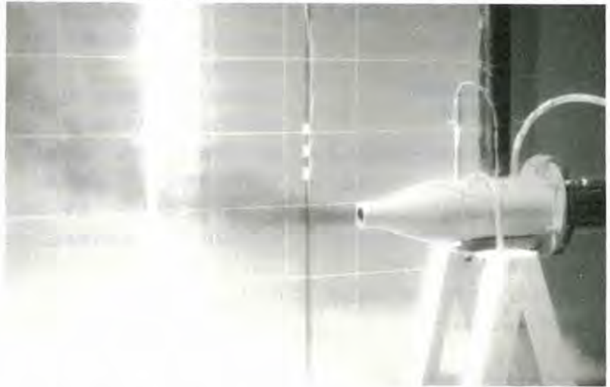
図2-2-2 温排水が海面下(静水中)で薄められ拡散していく状況
