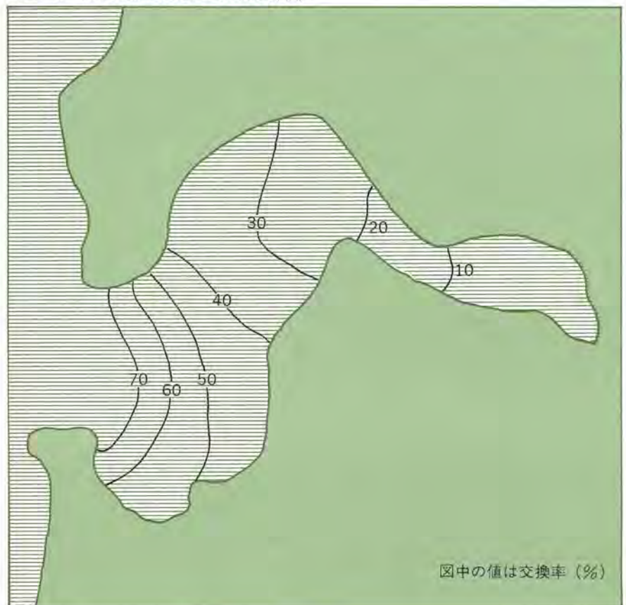
図2-2-13 海水交換率の水平分布(3ヶ月後)
