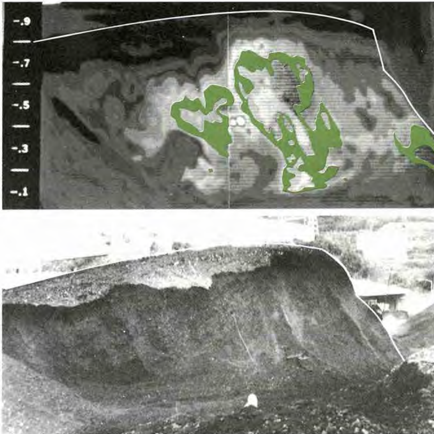
図2-1-15 石炭山の表面温度分布(緑のところが高温の部分)・上、石炭山・下
