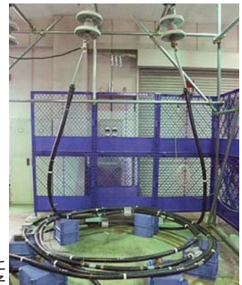
水トリーを発生させるためにケーブル試料に課電している様子
