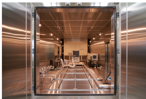
図2-3 ヒートポンプ性能評価試験設備 (環境試験室:W4.5m×D7.5m×H3.5m)
