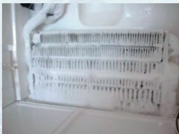
家庭用冷蔵庫の蒸発器の着霜イメージ
