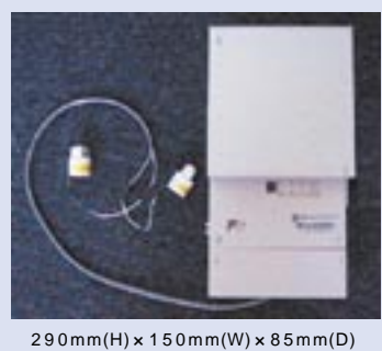
図1 非侵入型モニタリングシステム 需要家端末実用機
