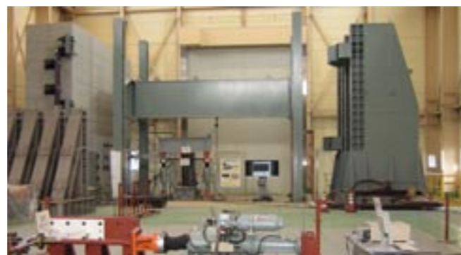
ハイブリッド動的力学試験システム（振動台）を使った実験風景
