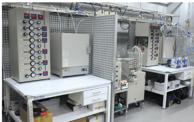
微量物質挙動評価装置 発電所などの実条件を模擬した環境での微量物質の基礎的な挙動解明が可能
