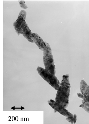
図2 大型製造装置を用いた新ナノ粒子成長法により合成した Ce_{0.9}Gd_{0.1}O_{1.95} ナノ粒子の電子顕微鏡(TEM)写真
