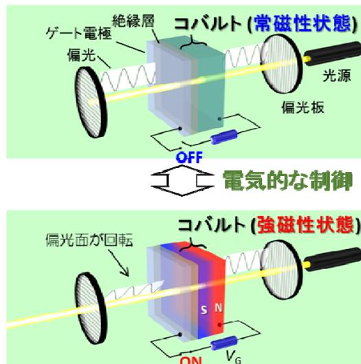
図2 光スイッチングの概念図
