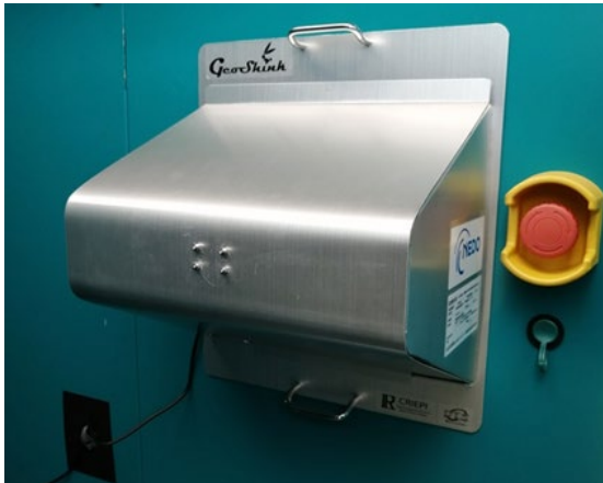
図2 「GeoShink™」のメーター撮影カメラの設置(左)およびIoT機器による監視画面(右)イメージ
